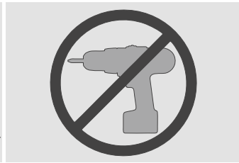
Регулировка производится отверткой. Не использовать шуруповерт!
