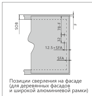
Позиции сверления для саморезов
